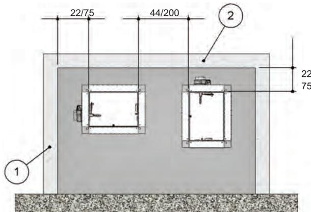
Distance minimum à vérifier en fonction du type d'installation
