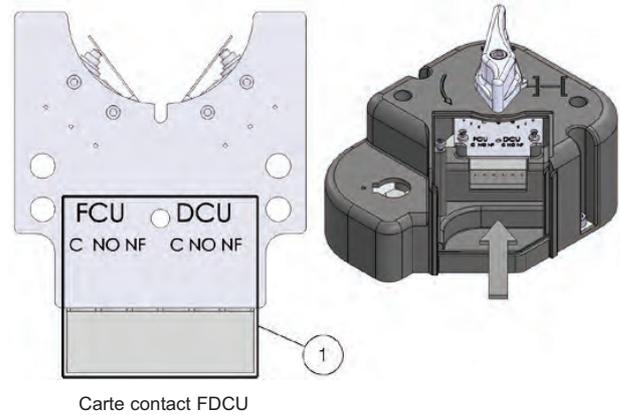
① Bornes de raccordement des contacts début et fin de course unipolaires FDCU :
