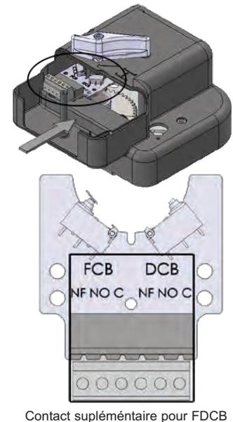
① Bornes de raccordement des contacts début et fin de course unipolaires FDCU :
