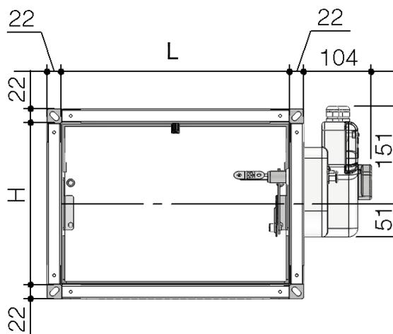
Il est recommandé de laisser une distance de 200 mm entre le clapet et tout autre obstacle pour l'utilisation du mécanisme ou pour l'entretien
