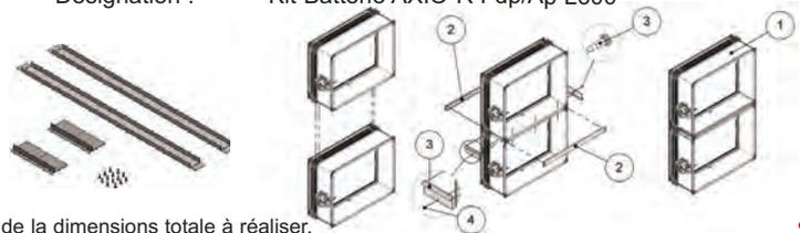
Pour sélectionner les dimensions des clapets constituant la batterie, veuillez déduire 45 mm de la dimensions totale à réaliser.
