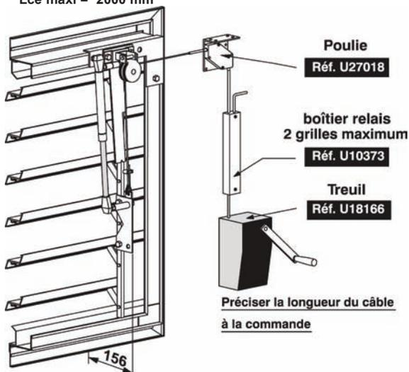
OUVERTURE / FERMETURE RÉGLABLE PAR VÉRINÉLECTRIQUE 230 Vca
