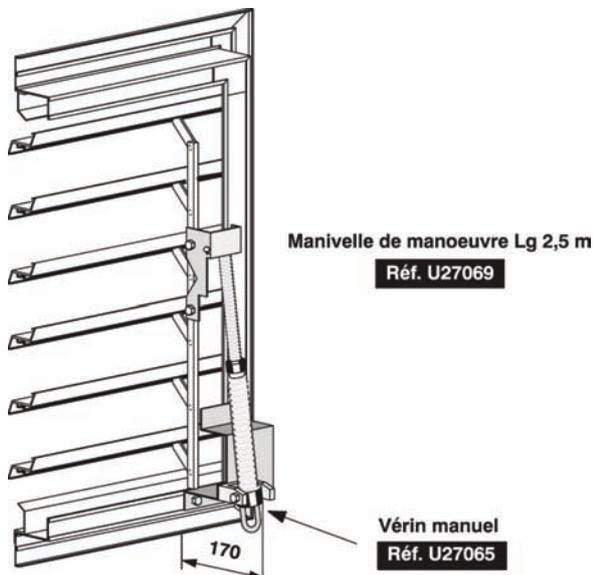
OUVERTURE / FERMETURE RÉGLABLE MANUELLEMENT EN FACE AVANT
