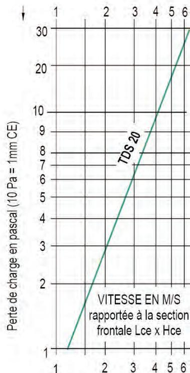
SURFACE EN M<sup>2</sup>• Surfaces de passage d'air en m<sup>2</sup>
